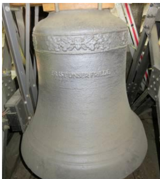
Die Inschrift lautet: „Er ist unser Friede“, Ton: C, Durchmesser: 95 cm, Gewicht: 300 kg
